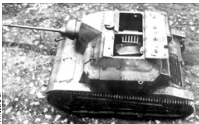
Tankietka TK-3 przebrojona w nkm wz.38 FK model A.
