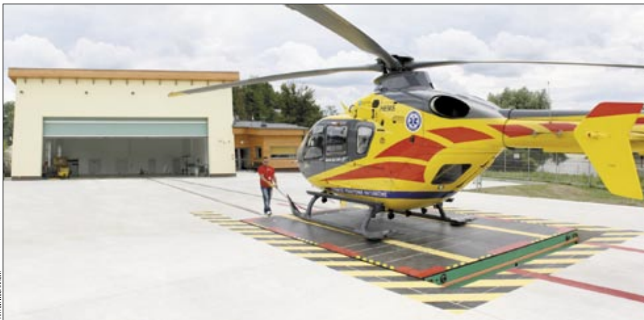
– To nie hangar, to piękny pałac dla naszego Eurocoptera – mówią piloci i mechanicy. A ten, postulatnie, na pilota trzymanego w ręce kierownika bazy Stefana Zubla, wjeżdża na platformie do wnętrza pałacu.
