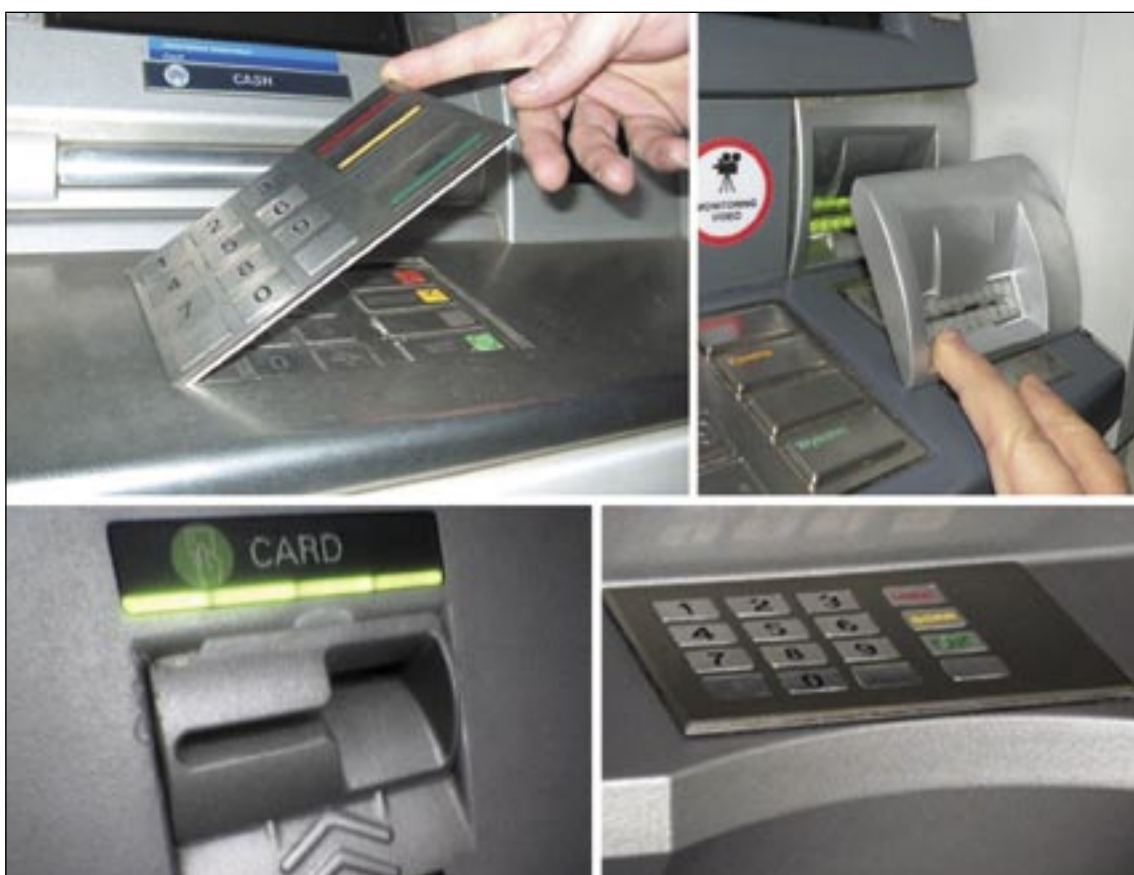
Przykłady nakładek bankomatowych stosowanych przez skimmerów. Niekiedy są tak ładnie zrobione, że bez uważnego „oglądu” nie sposób ich zauważyć.
