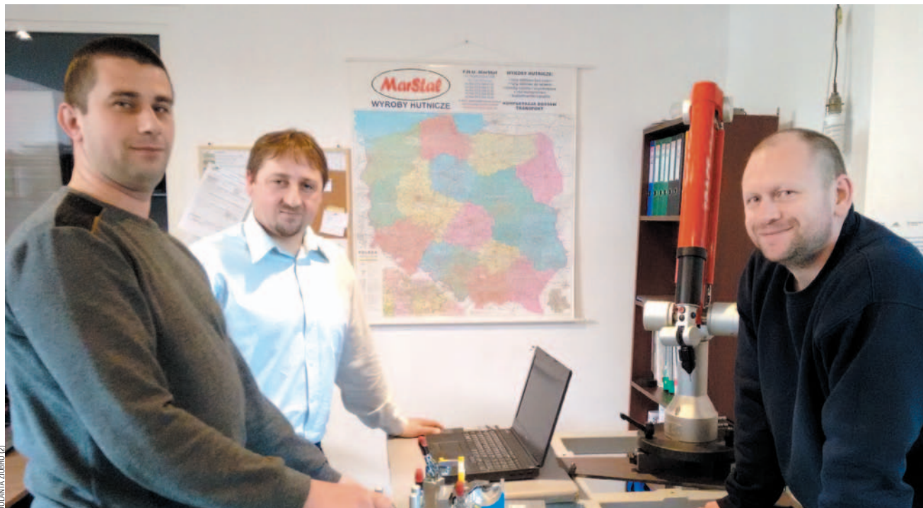
Przyrząd stojący na stole to współrzędnościowe ramię pomiarowe, które służy do sprawdzania geometrii, kształtów i wymiarów gotowego wyrobu. Przyrząd kosztuje, bagatela, 100 tys. zł. Na zdjęciu – konstruktorzy i Marcin Mołczan (na drugim planie)
