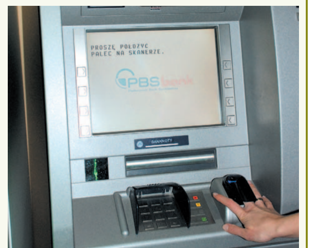
Bankomaty PBS wyposażone są w specjalne czytniki (skanery) układu naczyń krwionośnych
